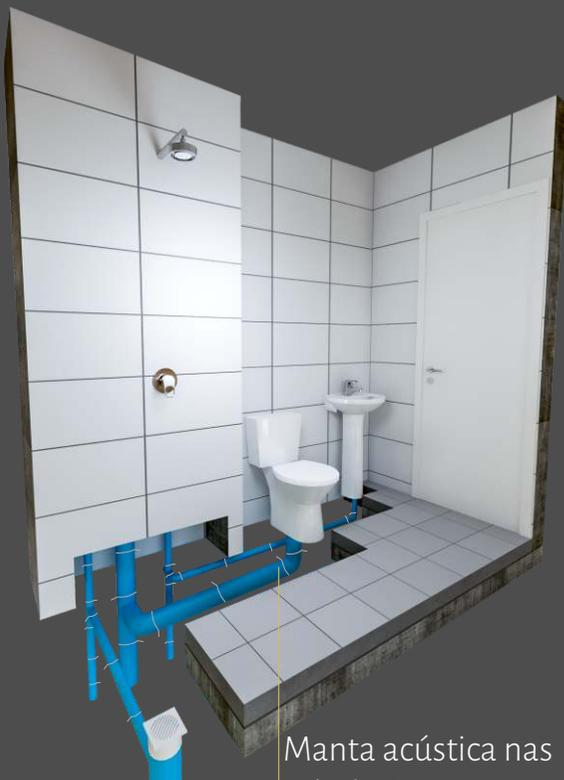
Manta acústica nas tubulações hidrossanitárias
